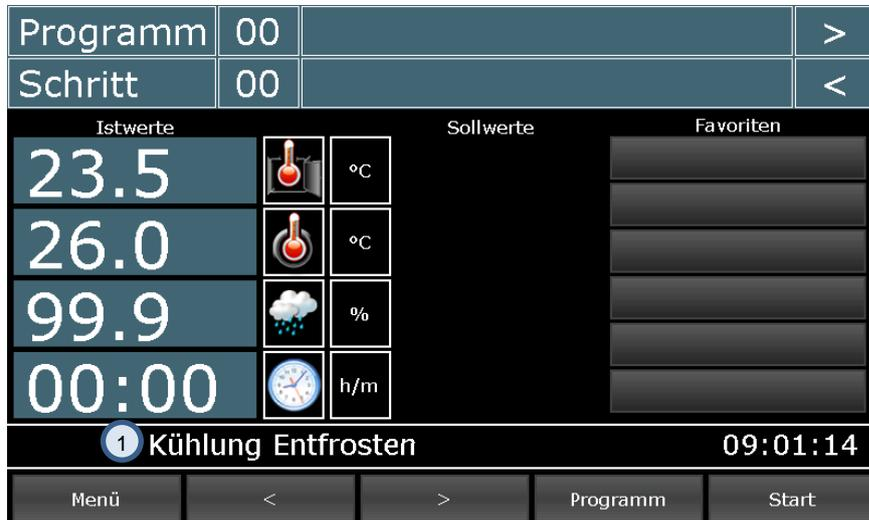
Abbildung 23: Betriebsstundenanzeige in der Statusleiste
