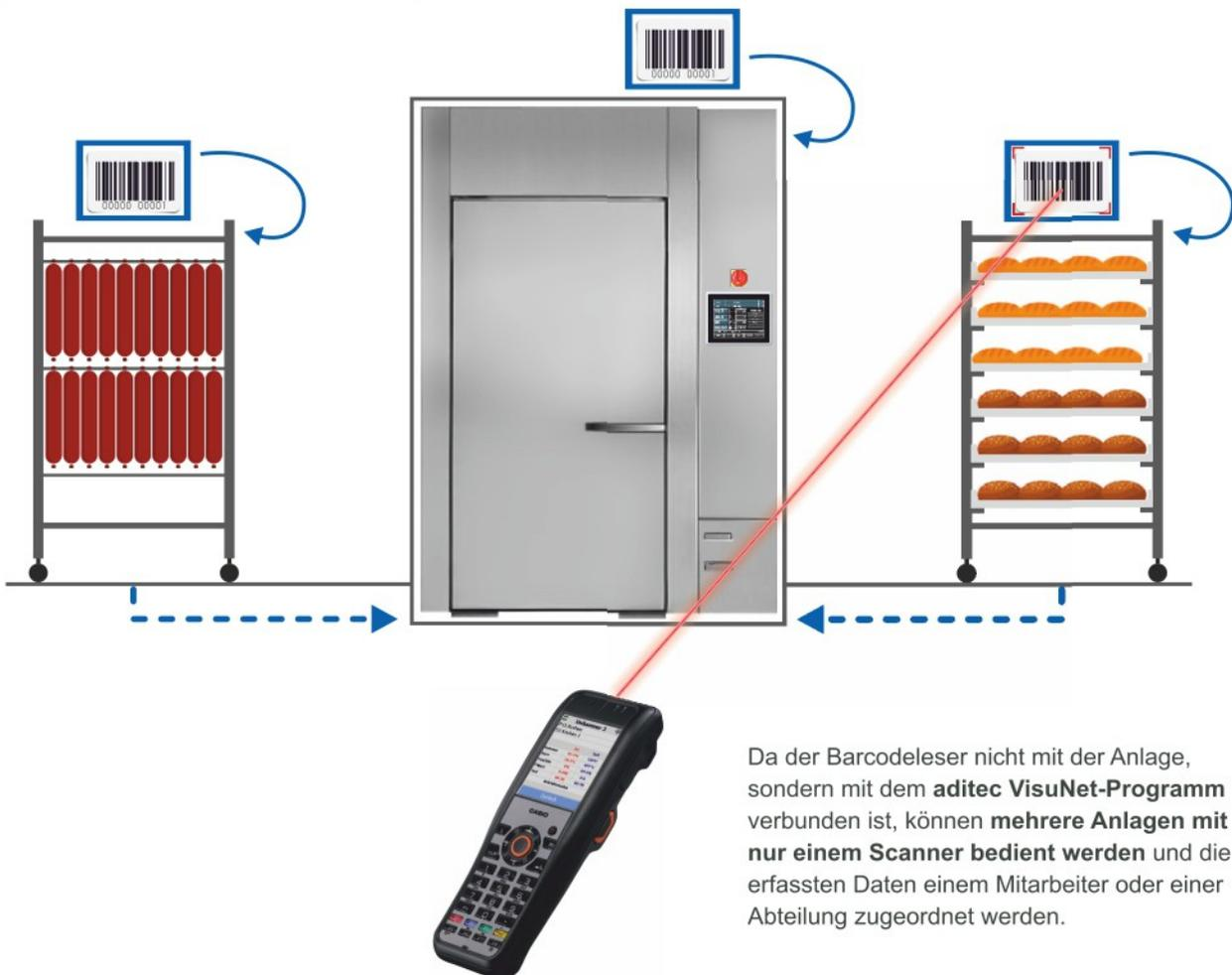
Da der Barcodeleser nicht mit der Anlage, sondern mit dem **aditec VisuNet-Programm** verbunden ist, können **mehrere Anlagen mit nur einem Scanner** bedient werden und die erfassten Daten einem Mitarbeiter oder einer Abteilung zugeordnet werden.
