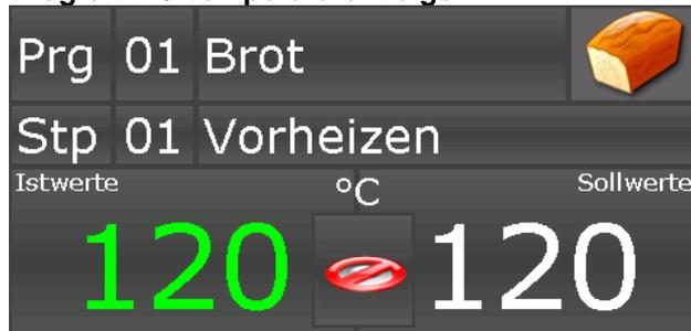
Beim Erreichen der Solltemperatur schaltet die Hupe für 5 Sekunden ein<sup>2</sup>. Auf der Position 4 erscheint ein Backzeichen. Beim Betätigen des Backzeichens erfolgt eine Schrittweitschaltung.
